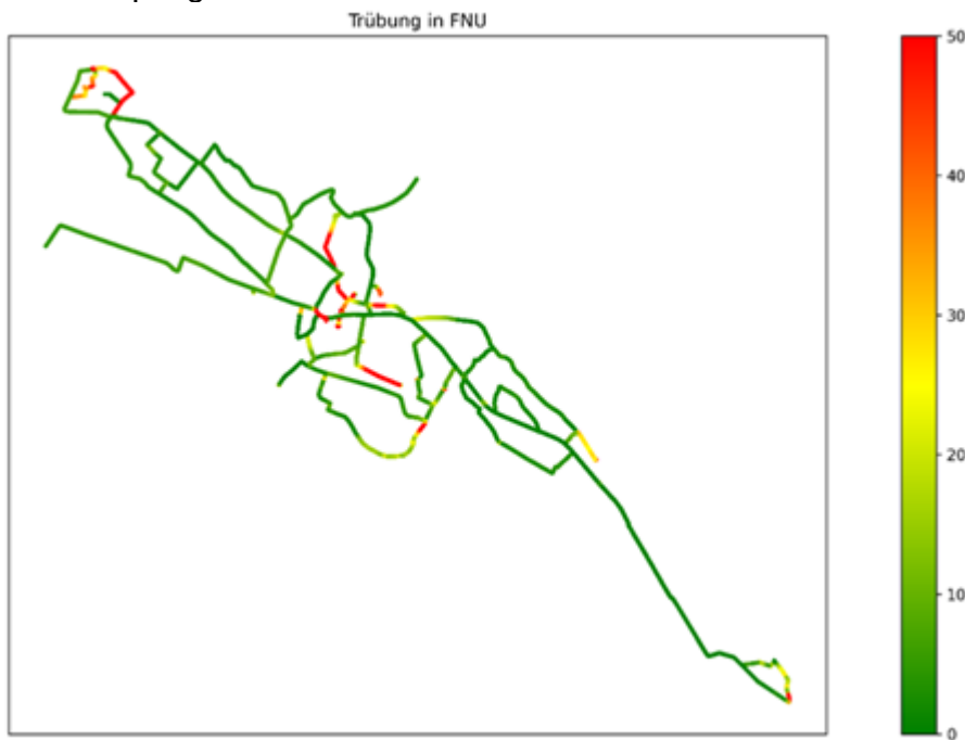
Abbildung 4: Ablagerungssituation bei Grundspülung Beispielgemeinde
