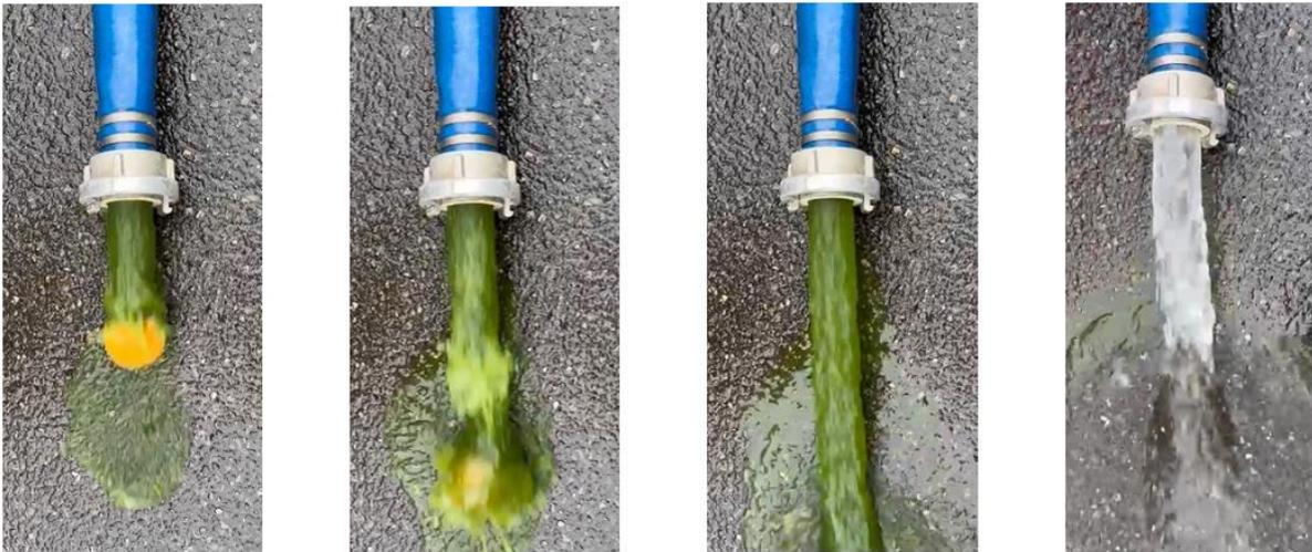
Abb. 8: mechanische Reinigung mittels Reinigungs- / Schwammkugeln
