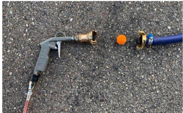
Abb. 12 bis 13: Beispiel - Ausblasen von Schläuchen mit gefilterter Druckluft und einer Reinigungskugel
