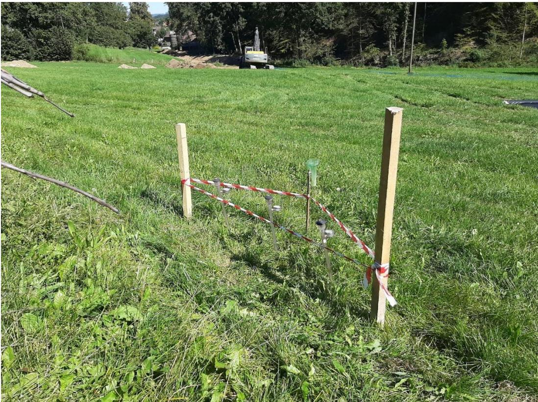
Abbildung 18: Tensiometermessstation. Foto RSW AG.
