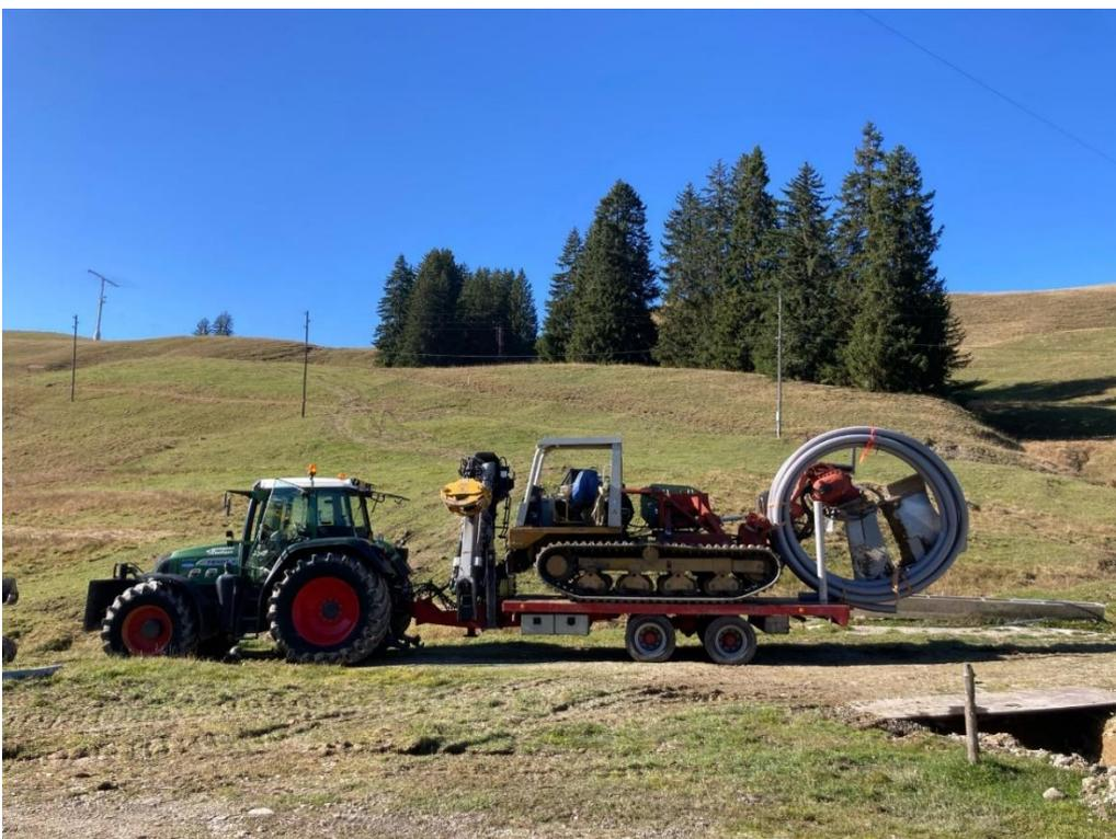
Abbildung 9: Installation Grabenpflug. Foto RSW AG.
