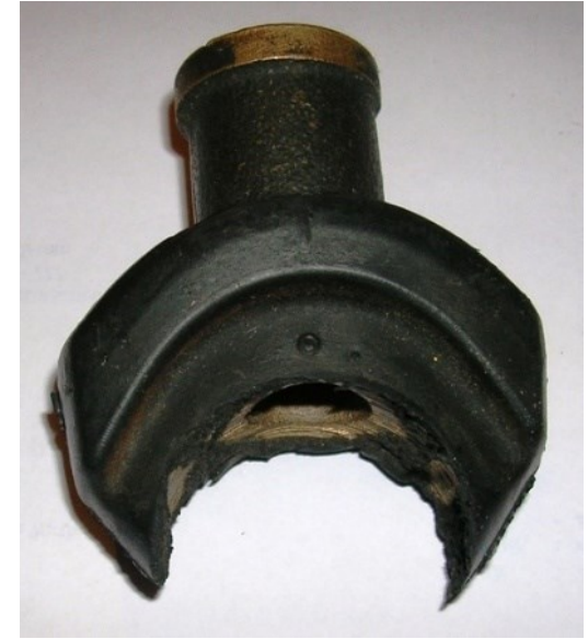
Folge eines Fehlers Durchbohrter Schieberkeil, (Schieber war nicht ganz offen)
