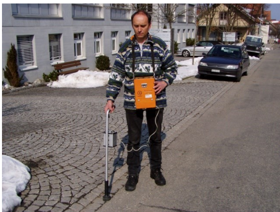
Trassenbegehung mit Sonde
