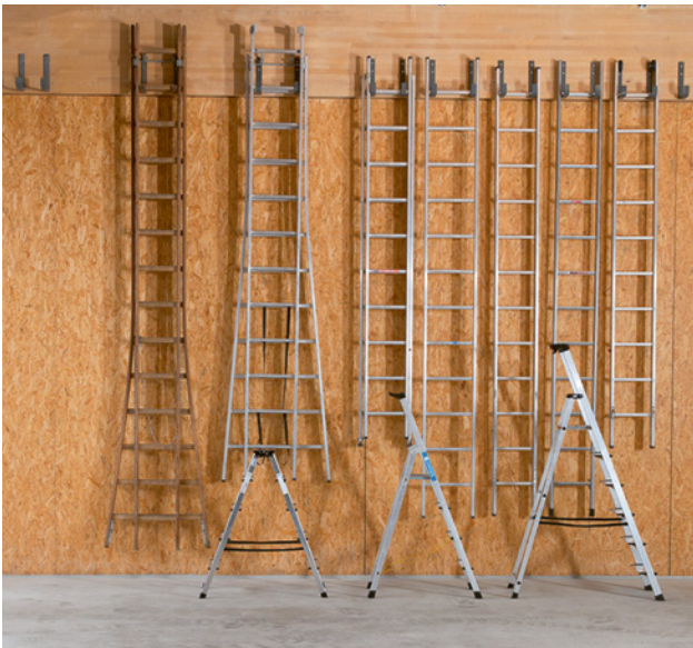
50 Saubere Lagerung – vor schädigenden Einwirkungen geschützt
