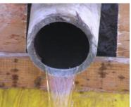
Eisenoxid- und Manganoxid-Ablagerungen, die das Trinkwasser im Verteilnetz verunreinigen können
