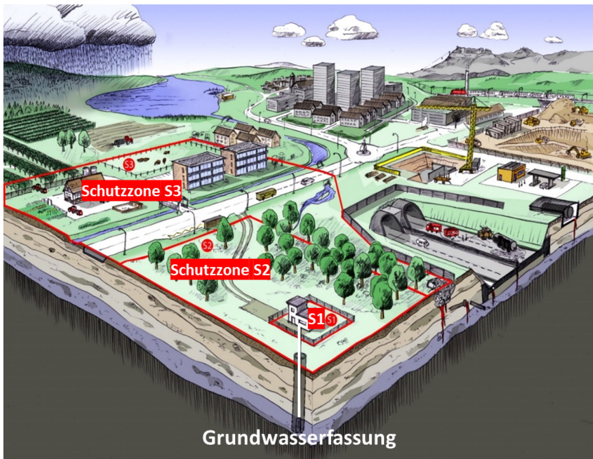
Abbildung 5 – Grundwasserschutzzone S3, S2 und S1 um eine Grundwasserfassung von öffentlichem Interesse
